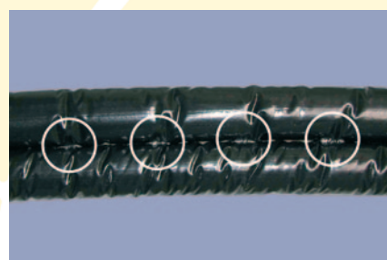
Spojení pomocí lepicích bodů
